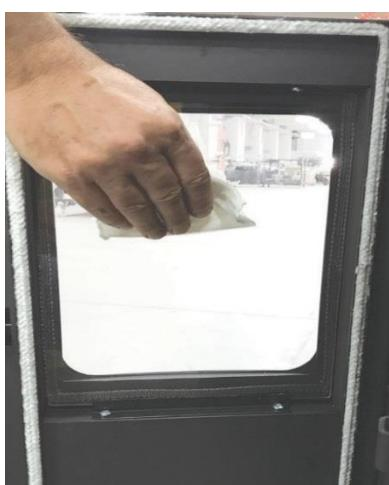
Během provozu kamen se sklo dvírek čistí samo proudem vzduchu. Po několika hodinách provozu se však sklo může zevnitř zaprášit. Hlavním důvodem je kvalita použitých pelet a kvalita odvodu spalin. Po každém čištění zkонтrolujte, zda během čištění nedošlo k posunutí skla z držáků. Dále zkonzrolujte izolační pásku mezi sklem a dveřmi. Při poškození vyměňte za novou. Na izolační pásku se nevztahuje záruka.
