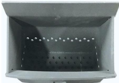
V závislosti na kvalitě pelet se v hořáku může vyskytovat struska jako zbytek spalování pelet. Pozor horké povrchy!!! Před čištěním se ujistěte, že hořák vychladl. Hořák vyjměte pohybem nahoru a vysypejte ho do nehořlavé nádoby s víkem. Je vhodné na čištění hořáku použít vysavač na popel.
